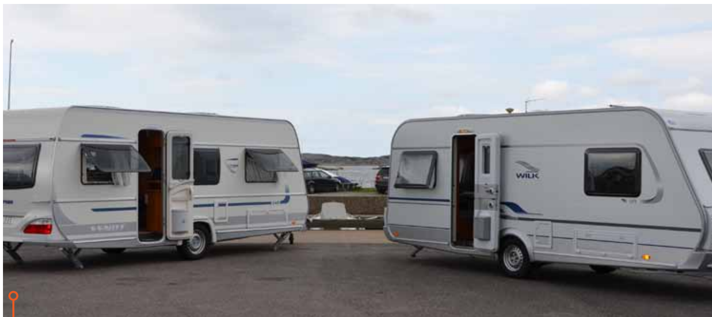
De yttre lastluckorna sitter på höger sida i vagnens färdriktning.
